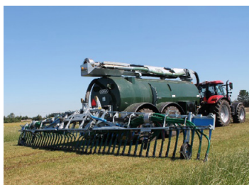
Bild 17. Gödseltunna eller tankvagn med släpfotsramp ger ofta högre markpackning. Foto: Christer Johansson
