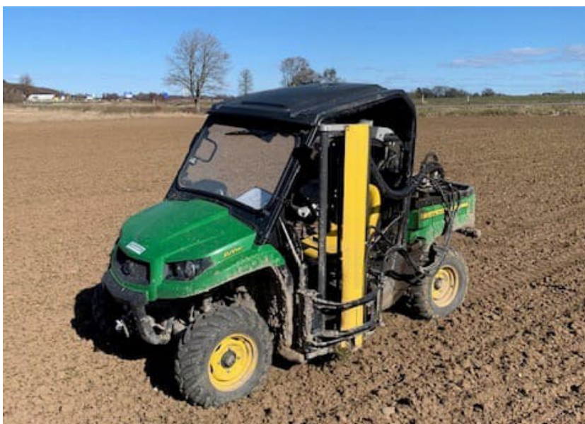
Bild 1. Oftast tas jordprover vid markkartering med jordborr som är monterad på en fyrhjulning. Provplatsernas positioner fastställs med GPS. Foto: Magnus Westöö
