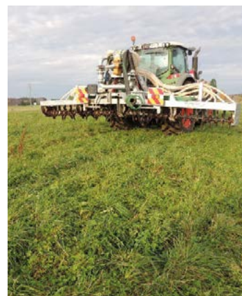
Bild 20. Traktor med matarslang och myllningsaggregat för spridning i vall minskar ammoniakförlusterna. Foto: Pernilla Kvarmo
