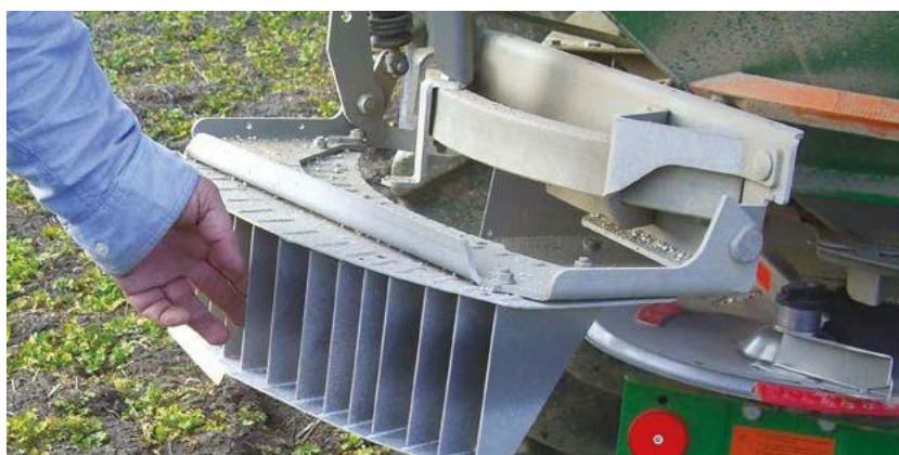
Bild 15. Använd lämplig spridningsteknik för att utnyttja gödseln optimalt och minimera förlusterna. Kantspridningsutrustning minskar risken för att gödseln hamnar utanför fältet. Foto: Jens Blomquist
