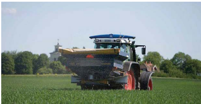
Bild 23. Kvävesensorn på traktorns tak läser av grödans färg och täthet. Gödselspridaren varierar sedan kvävegödslingen efter grödans behov. Foto: Lantmännen
