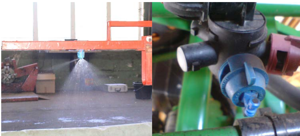
Bild 16 visar ett munstycke som inte har en jämn spridningsbild. Ett sådant munstycke bör leda till att alla munstycken av denna storlek på sprutan bör bytas ut. Till höger på bilden syns ett järn som ska förhindra att munstycket får markkontakt, moment F9.
