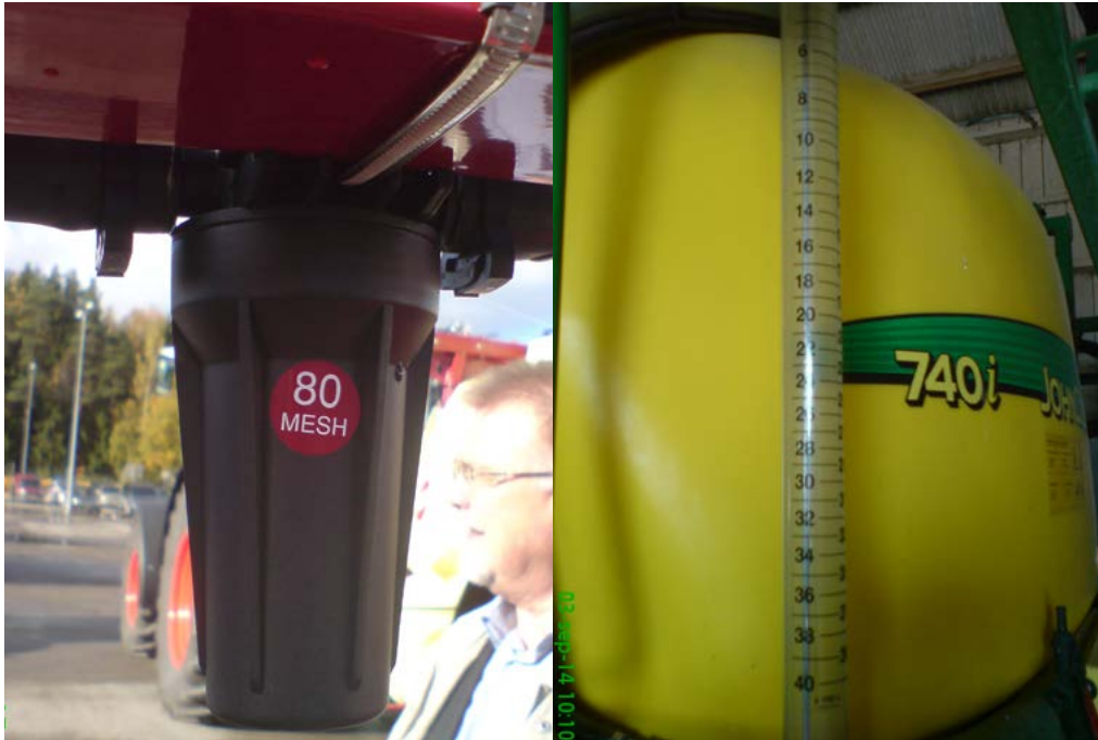
Bild 10 till vänster. Rampfilter med maskstorleken tydligt utmärkt. Vilken maskstorlek filtren ska ha styrs av vilka munstycken du använder. Bild 11 till höger. Tank med ett rör där vätskenivån i tanken kan läsas av.
