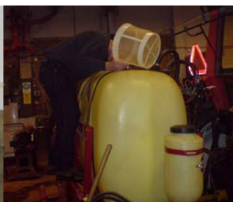
Bild 8. En hel påfyllningssil ska finnas under tanklocket. Arbetar du med något annat än helt oanvända sprutor bör du ha skyddshandskar. På bilden syns även en mindre vattentank som ger möjlighet till avsköljning.
