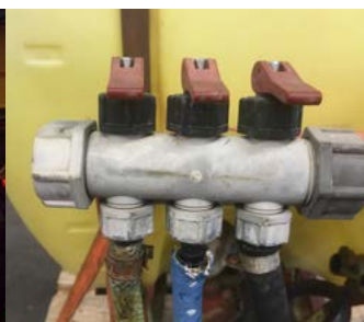
Bild 9. Slitna slangar och dåliga anslutningar. När det är så här olika slangtyper kan det vara en indikation på att fel typ av slang använts.
