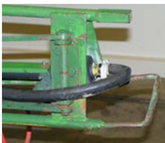
Bild 7. I vecket på slangen som ibland bildas när rampsektionerna fälls ihop bör du särskilt undersöka att slangen inte skadats.
